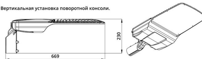
Угол регулировки поворотной консоли ±20° с шагом 5°.
